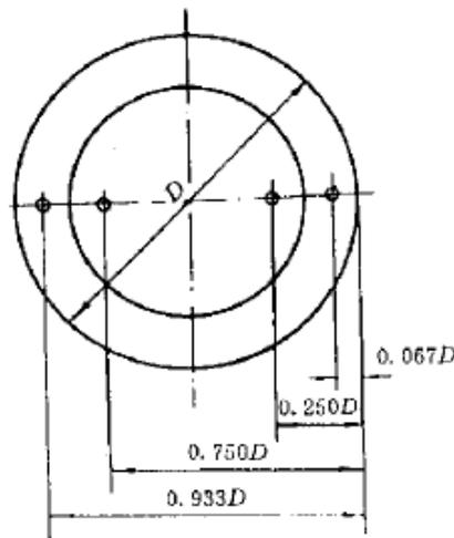
图2 采样点距烟道内壁距离
