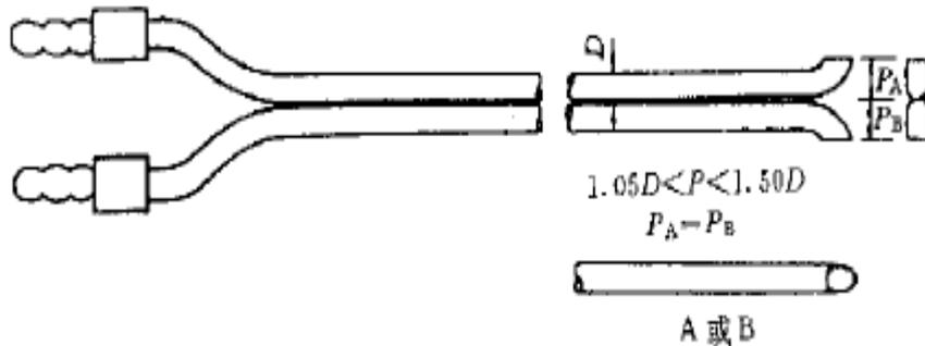
图4 S型皮托管
